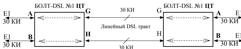
Рисунок Е.1 – Схема организации связи согласно ТК0.
