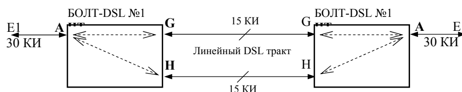
Рисунок Е.2 – Схема организации связи согласно ТК1.
